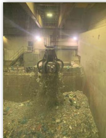
Ein Highlight waren die beiden Kräne, die für das Durchmischen des Müllbunkers sowie das Befüllen der Trichter zu den Öfen verantwortlich sind, sowie Geschichten über die kuriossten Gegenstände, von radioaktiven, medizinischen Proben, über WC-Schüsseln bis hin zu einem VW-Kleinbus, die von den Müllwägen der MA48 angeliefert wurden.
