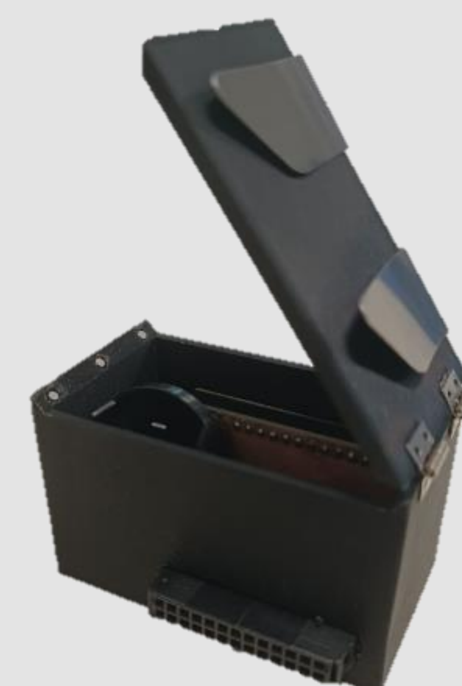
Abbildung 2: Gehäuse des Systems (inkl. Microcontroller und Sensorschaltung)
