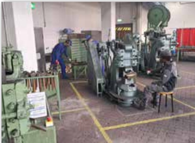
Arbeiten am großen Federhammer (vorne) und beim Lochen (im Hintergrund).
