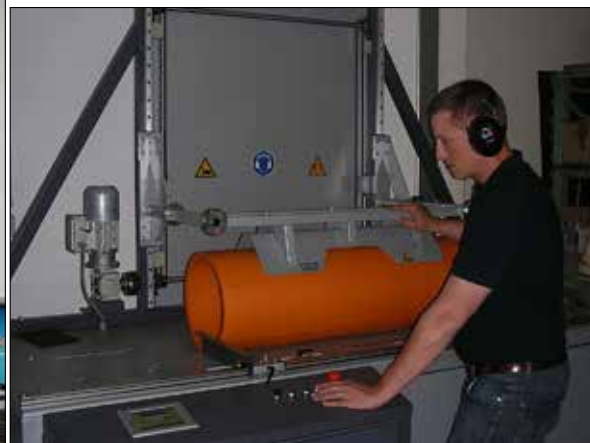
Bild 2: Kerbfräsmaschine der Firma ipt zum Kerben von Rohren für den Notch Pipe Test (NPT)
